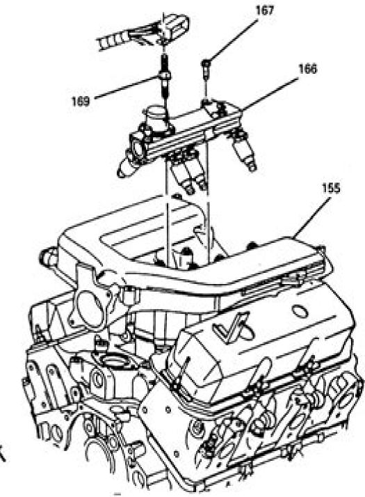
155 MANIFOLD ASSEMBLY, UPPER INTAKE
