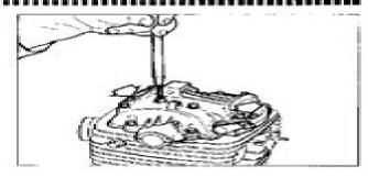
Fore attenzione ne inmortaggio a non scambiare le viti di divarsa unahezza: à consigliabile, prima di eseguire il serraggio, inserire la vita calla sede stabilitur se il gambo della vite sporge dalla sede di circa 12 e 13 mm la visa è nella corretto posizione. Fare attirrizione anche al e due viti più corto cho devuno essere insente, senza rondella, all'interno del caperchio.
