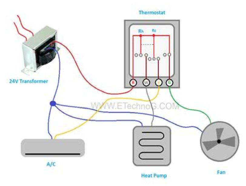
**Thermostat Wiring Diagram**
